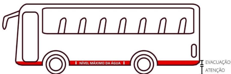
Figura 05. Modelo de faixa a ser adotado em todos os ônibus, indicando a necessidade de evacuação.
